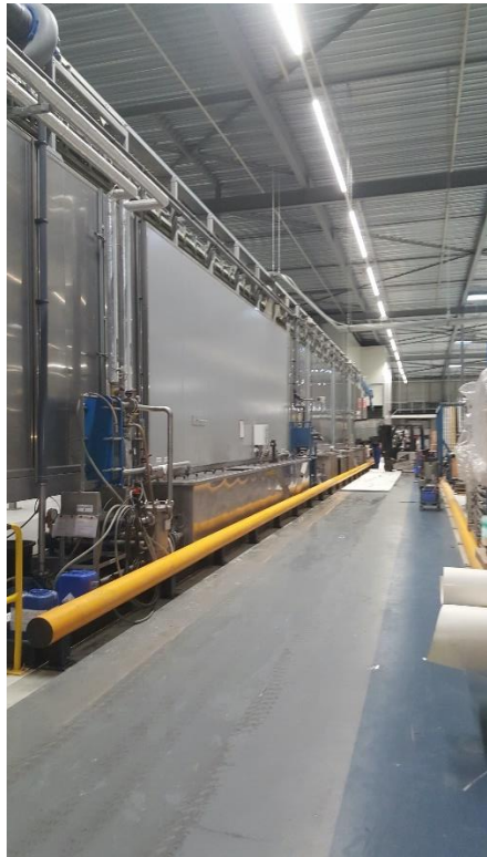
Afbeelding 3 Circulatiesysteem met vaste leidingen en baden
